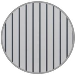
Rohrfüllung Ø 25 mm an die Konstruktion angeschweißt.
